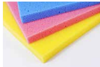
上图: Confor 泡沫用来吸收和消散冲击和碰撞。
